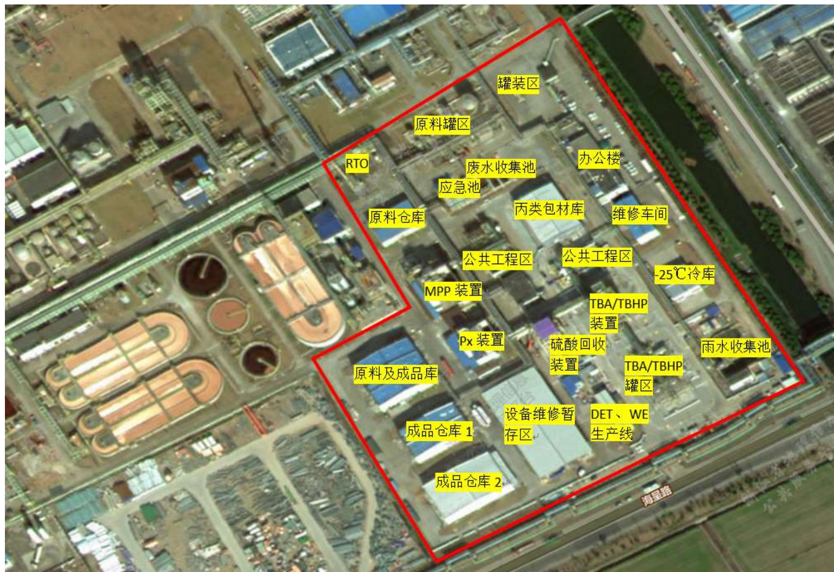
图 3.2-1 聚合物工厂厂区平面布置图
