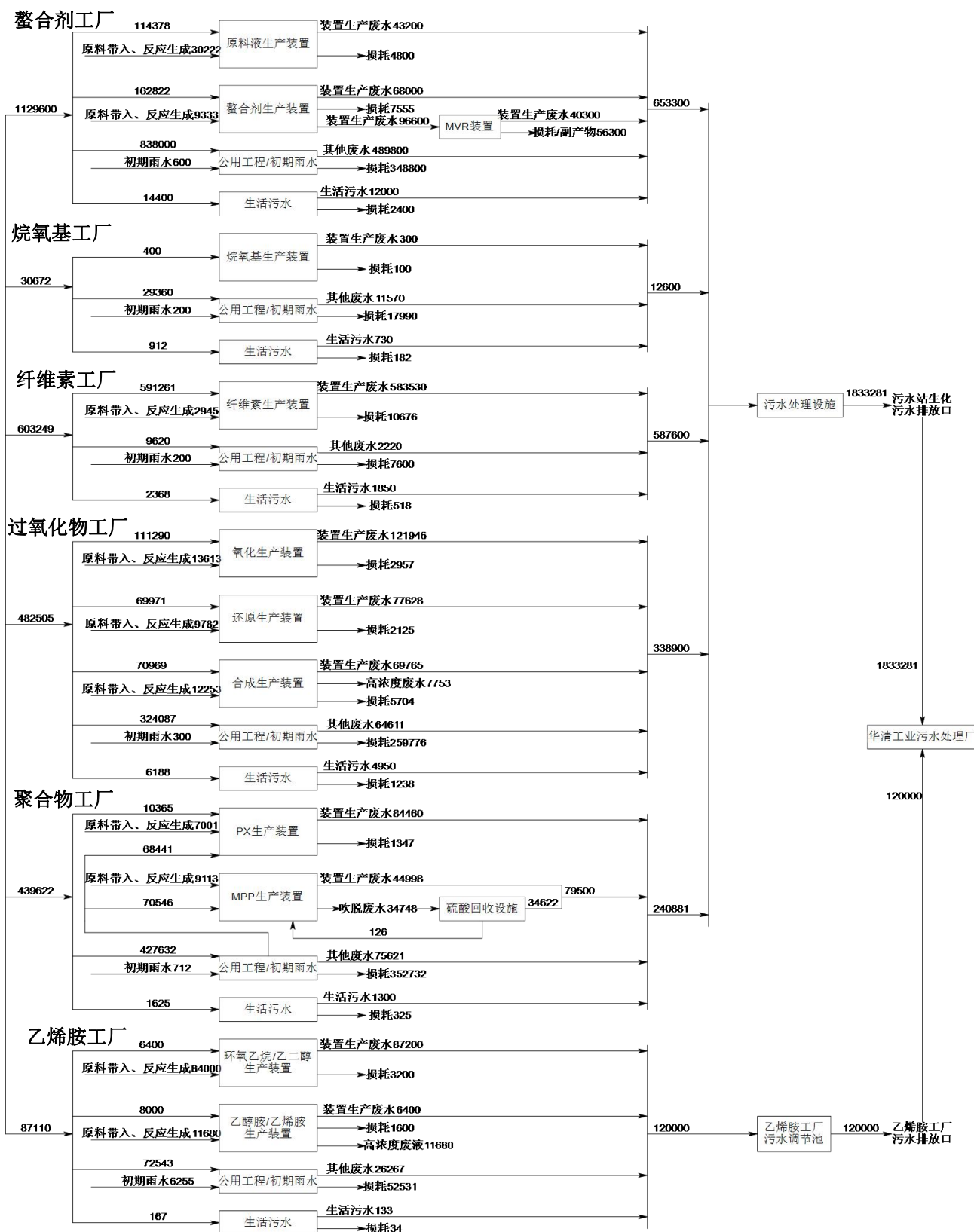
图4.4-2 本工程实施前全厂水平衡图 单位: t/a
