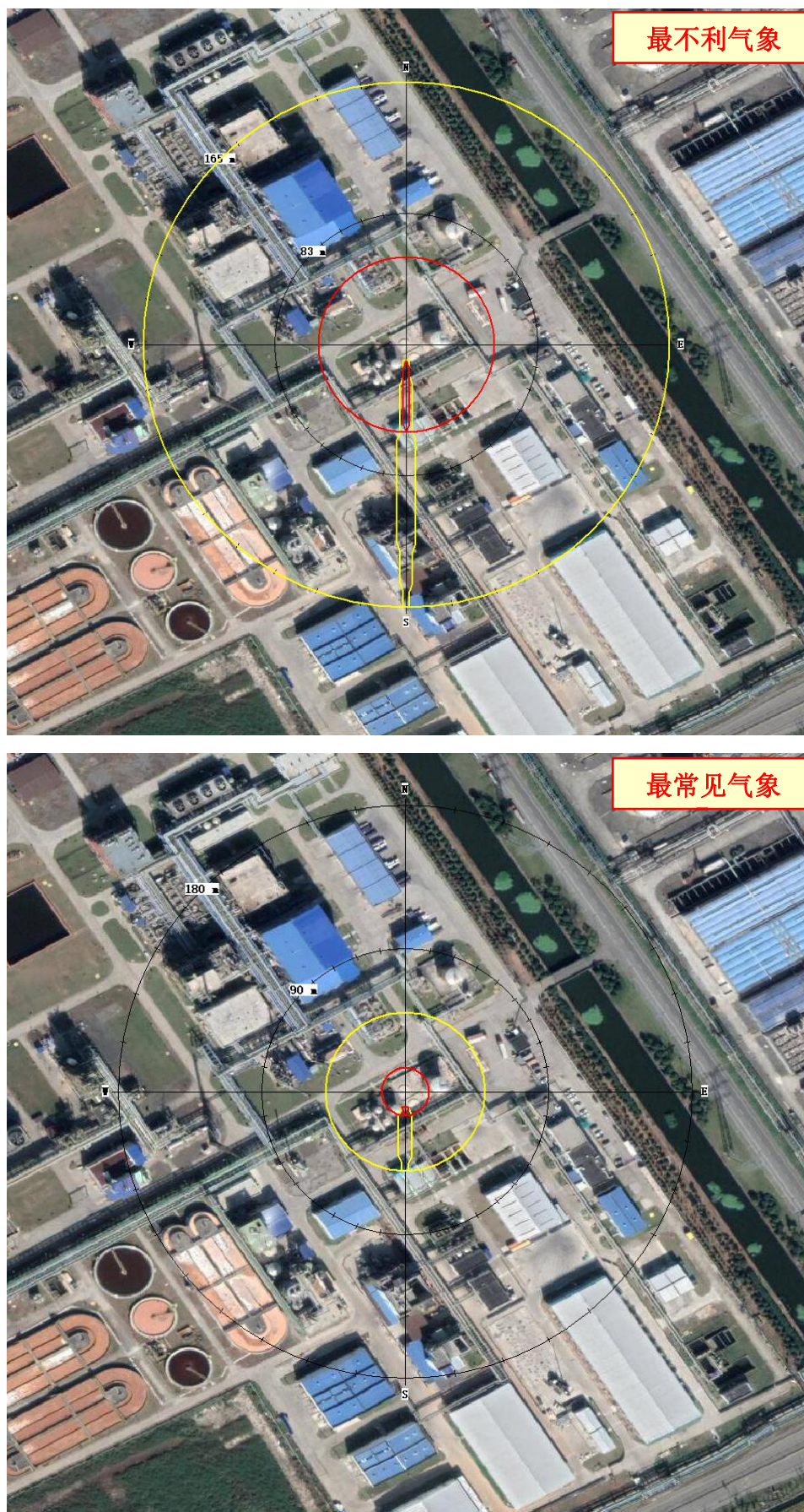
图 7.5-2 叔丁基过氧化氢储罐泄漏事故最大影响区域
