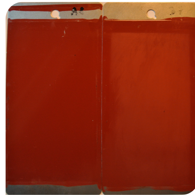
图2. 300小时QUV耐老化测试外观。样品A，包含Duomeen TDO表现出更低的降解和变浅趋势
